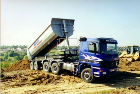
LKW mit aufgestelltem Kipper. Bodeneinbau in Kiedrich >Sandgrub<
